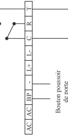
Au repos, la gâche maintient mécaniquement la porte verrouillée. Lorsque le relais est actionné par la centrale, le courant passe et la gâche libère la porte (appui sur bouton poussoir ou passage d'un badge autorisé).
