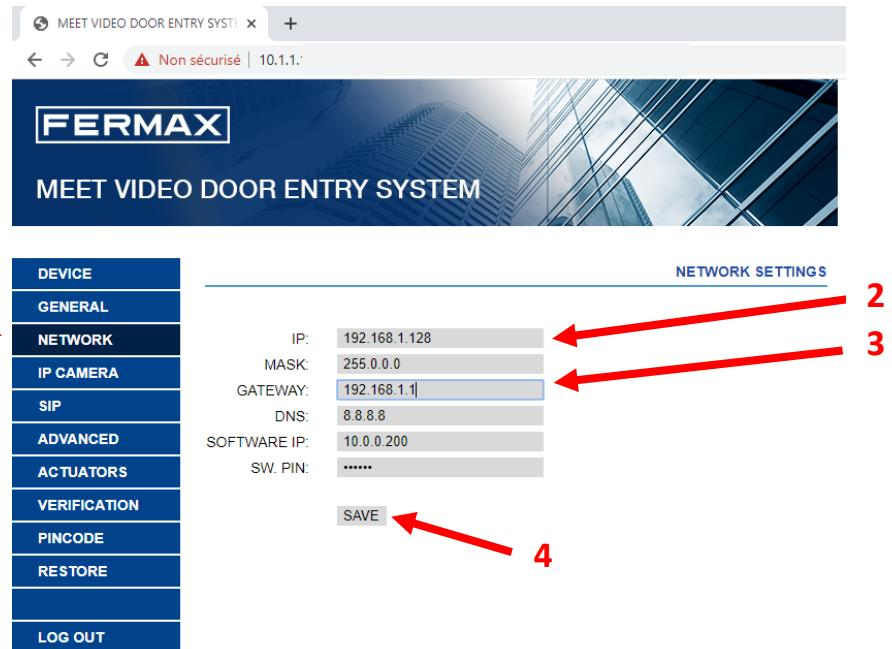
In dit voorbeeld hebben we het IP-adres 192.168.1.128 toegewezen aan de monitor omdat dit het eerste IP-adres van het vaste bereik van de router is en in "Gateway" hebben we 192.168.1.1 aangegeven omdat dit het IP-adres van de router is.
