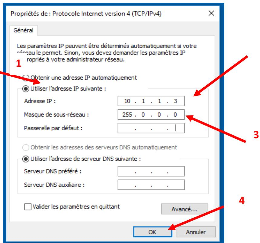
Voordat u verder gaat, kunt u "IPCONFIG" uitvoeren vanaf de opdrachtprompt om het IP-adres van de PC te controleren en vervolgens "PING" om te controleren of de MEET-componenten zich op het netwerk bevinden
