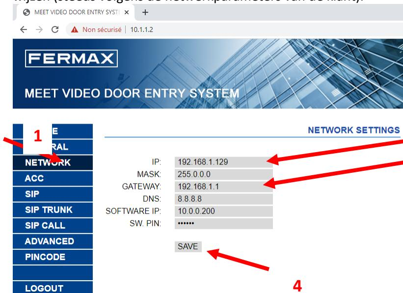
Herhaal deze procedure door een ander VAST IP-adres toe te wijzen aan alle MEET-toestellen in het systeem (monitoren en/of deurposten).
