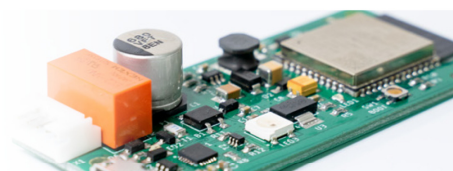
Enkel spanning nodig (8-30V DC, 6-24V AC), 1 relaissturing NO/NG tot 2A. Erg compact 73 (L) x 32 (B) x 14 (H) mm.
