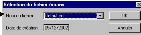
Il est possible de personnaliser les écrans pour une installation particulière. Il faut ensuite les sauvegarder sous un autre nom de fichier. Il faut le choisir dans la liste en utilisant la flèche. Valider le choix par **OK**. Il est alors nécessaire de charger les écrans dans le portier (voir chapitre '*Envoi des données*').
